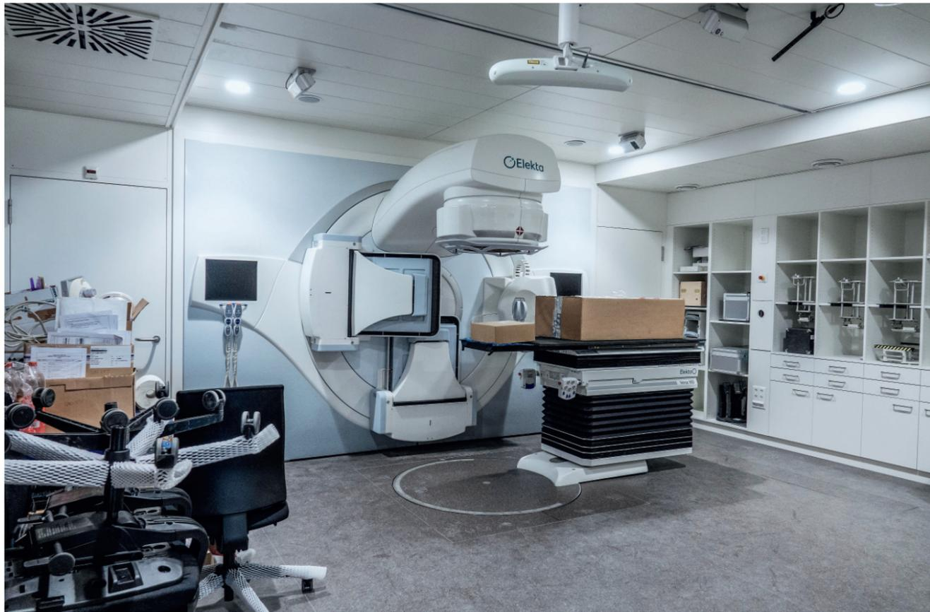
Le service de radio-oncologie est équipé de deux accélérateurs linéaires dont un couplé à une IRM. La technologie change si vite que l'HRC a attendu le dernier moment pour s'équiper. Pour protéger les employés des rayonnements, les murs sont en béton baryté et font un mètre d'épaisseur.
